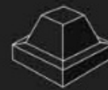
DS 1 Die and Weathered Plinth
